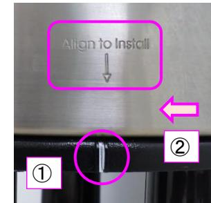
2. カチッと音がして、ポット回転止めロックがロックしたら回転を止める。
