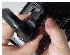
(2) ハンドルを上向きにし、ゲージガラスカバーを上にスライドさせてゲージガラスカバーを外す。
