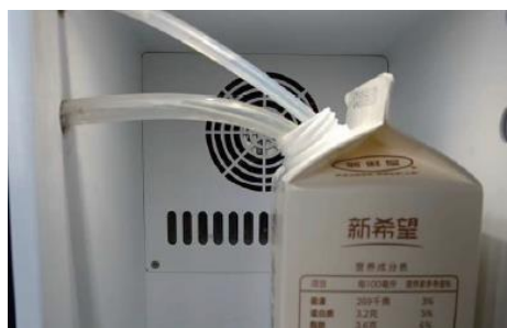
② 両方のチューブをミルク容器の中に入れます。
