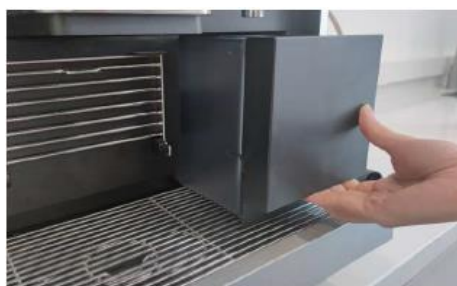
① 水タンクを取り外します。
