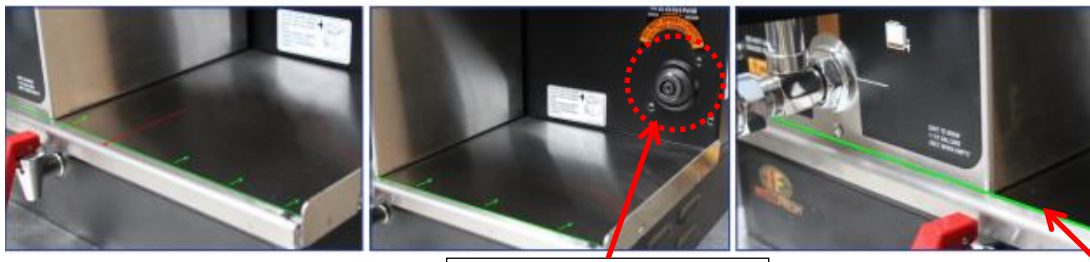
コンテナ電極に接続
