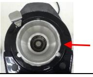
ねじ穴 | 上刃は正面に手固定ねじが右側に来るよう配置し、1-4の逆の手順で組み立てる。調節リングは1で外した時の回転数分元に戻す。 |
