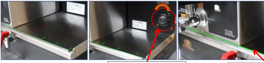
コンテナ電極に接続
