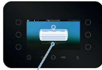
ボイラーヒーティング表示
